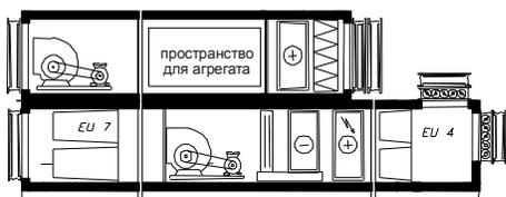
Приточно-вытяжный ансамбль с рекуператором - тепловой трубкой
