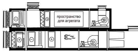
Приточно-вытяжный ансамбль с фреонным охладителем и охладительным агрегатом (верхняя часть предназначена для вытяжки воздуха из помещения и охлаждения конденсатора капель)
